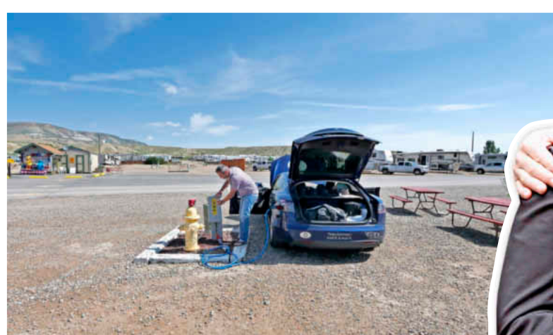
Aufladen in der Pampa: Hier nutzen die Elektropiloten den Starkstromanschluss eines US-Campingplatzes. Rieger sagt: »Da brauchst du zum Laden bei sieben Kilowatt die ganze Nacht.«
